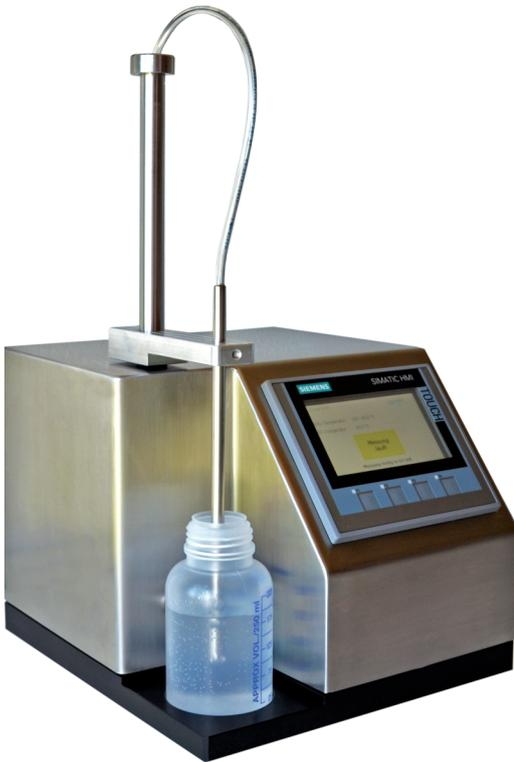
Das RTG TENSIOTEST T90 ermittelt über die Messung der dynamischen volumetrischen Oberflächenspannung den Gehalt der freien Tenside im Reinigungsmedium. Hierzu wird das T90 mit dem verwendeten Tensid kalibriert. Danach kann die aktuelle Reinigungsleistung des Bades schnell und zuverlässig ermittelt werden (Ausgabe in %).
